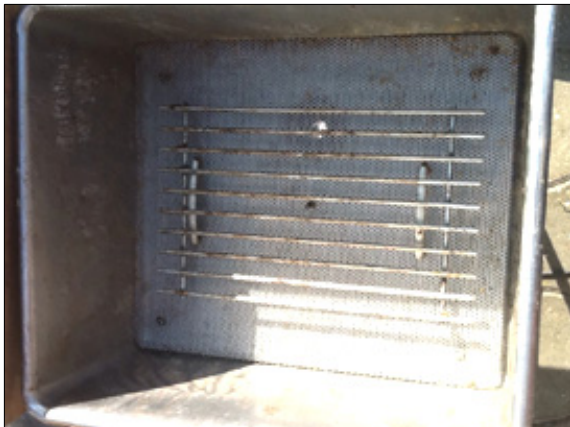
Stålvask med hulplade som si nederst og en stålrister ovenpå, så rammerne holdes fri af snask og døde bier.
