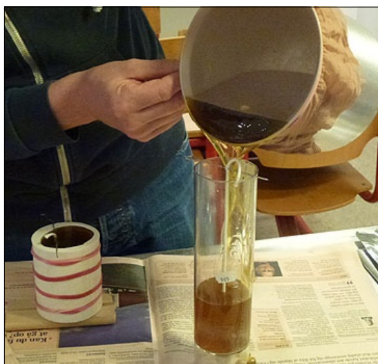
Voksen hældes gennem nylonstrømpen for at filtrere urenheder. Læg mærke til kødnålen der holder vægen på plads i midten af lyset.
